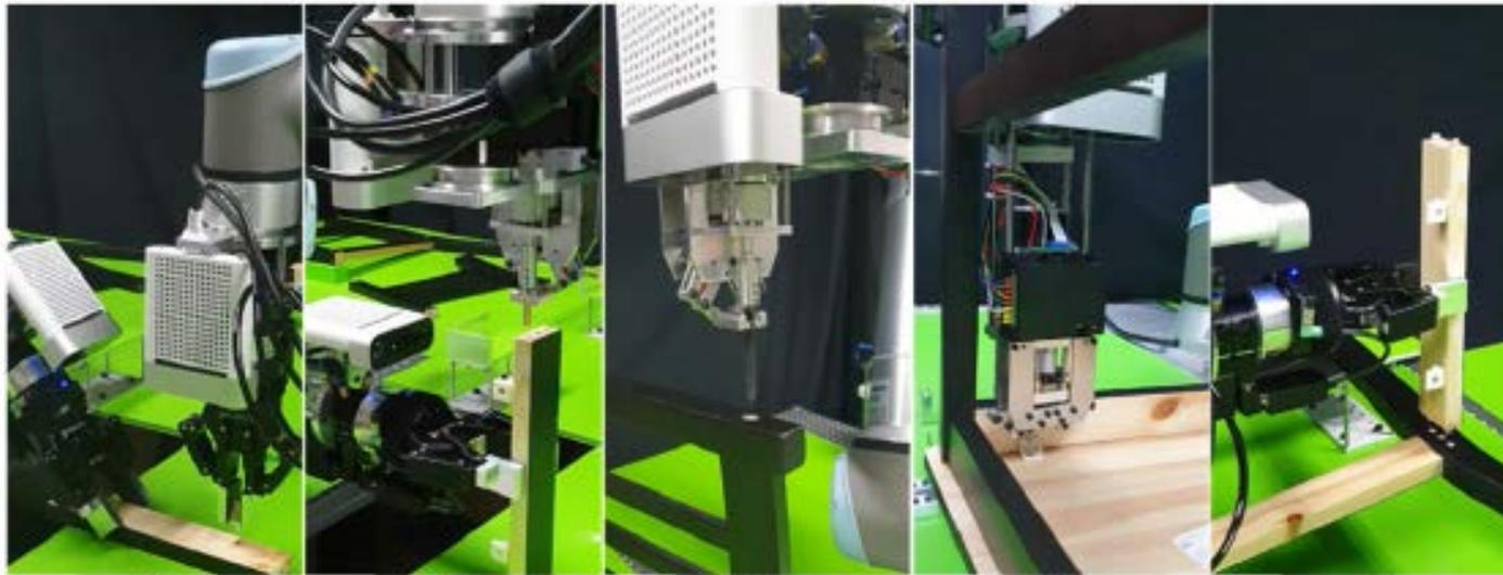
(a) 브라켓 조립, (b) 핀 조립, (c) 긴 나사 체결, (d) 짧은 나사 체결, (e) 목재 부품 조립
