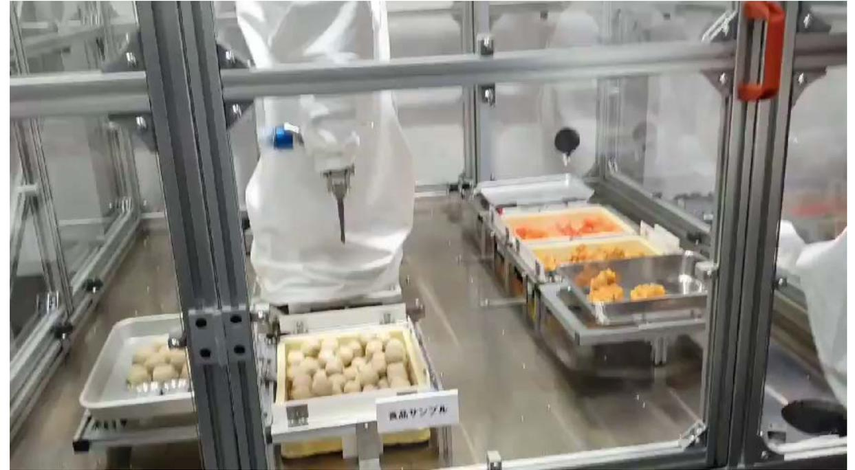
ルチモーダルAIによる塩の秤量 by collaborative robot COBOT
